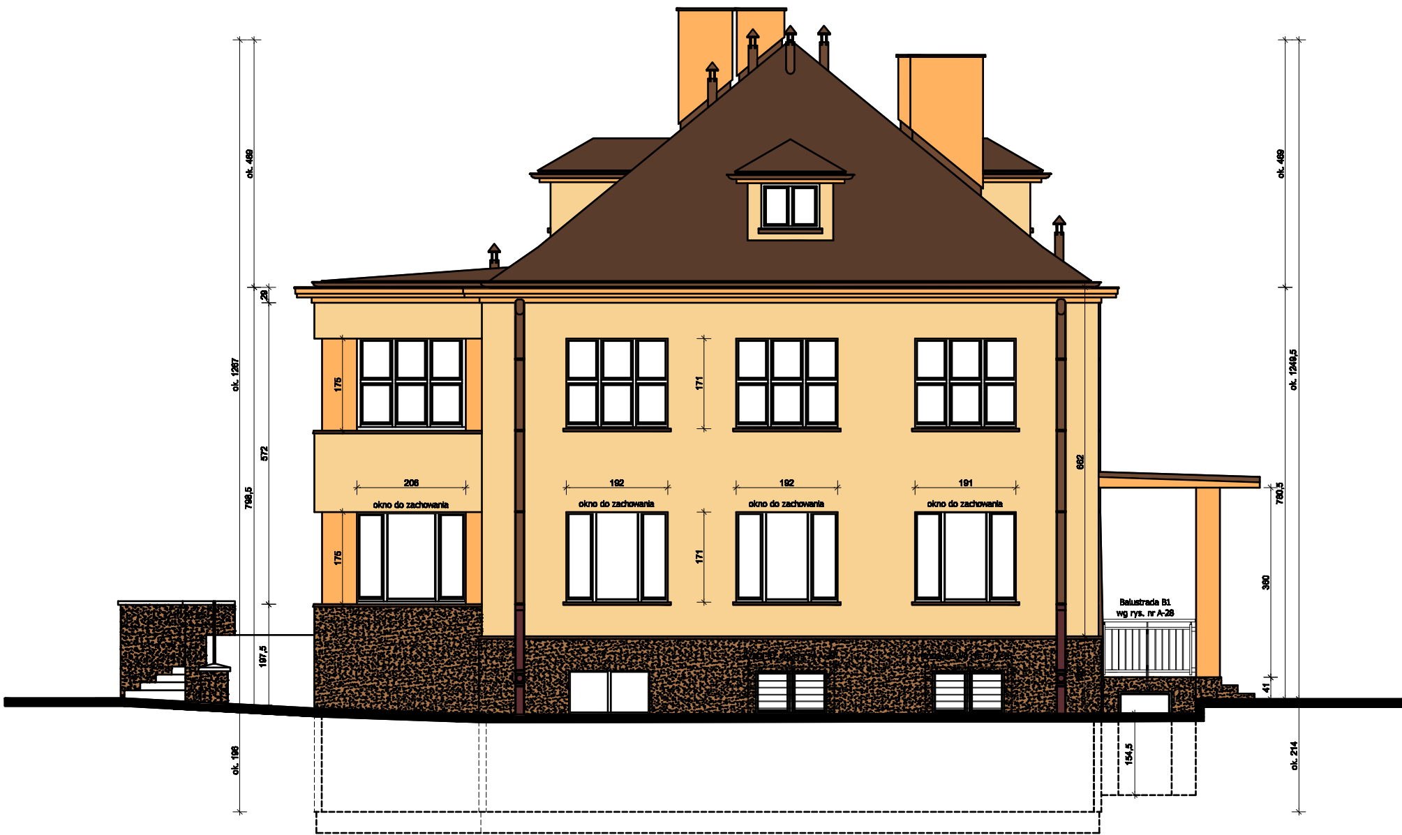
ELEWACJA PÓŁNOCNO - WSCHODNIA - stan projektowany, skala 1:100
