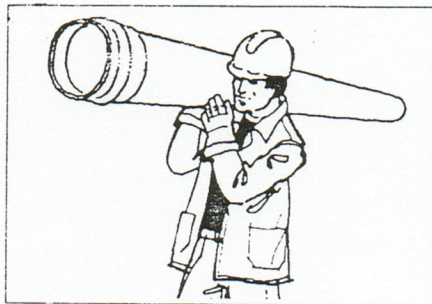
Rys. 11 Rury o mniejszych średnicach można przenosić bez użycia sprzętu
